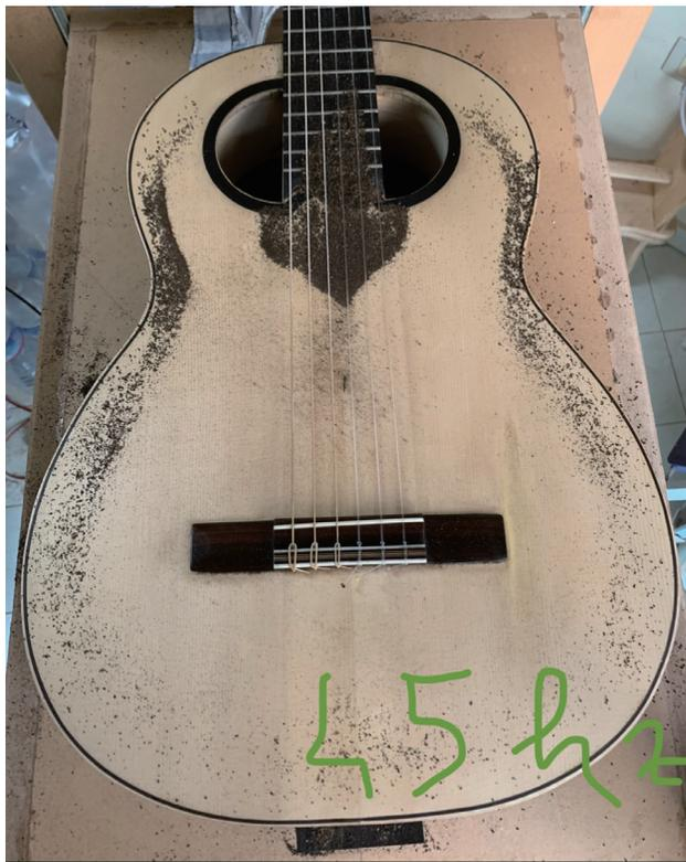
写真2：筆者の楽器の性能の分析的のために使うサイマティクス・テスト。このギターの最低周波数はコントラバスの最低音に近い45 Hz。
