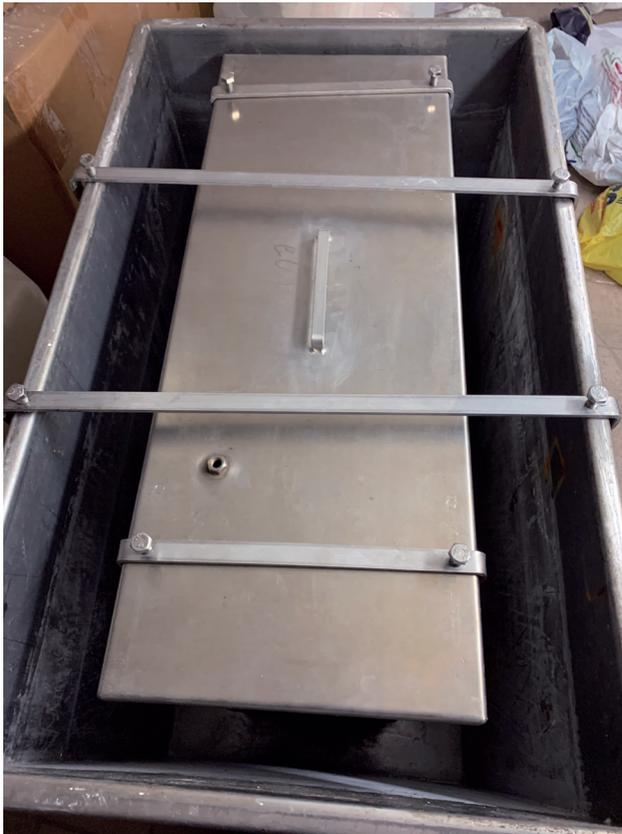
写真4：表面板に使用しているケイ酸カリウム浴用のステンレス鋼タンク
